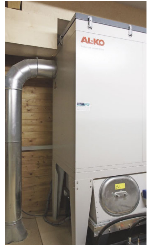
Die Power Unit 250 hat einen Volumenstrom von 4900 m³/h. Die Presse verarbeitet bis zu 70 kg/h.
